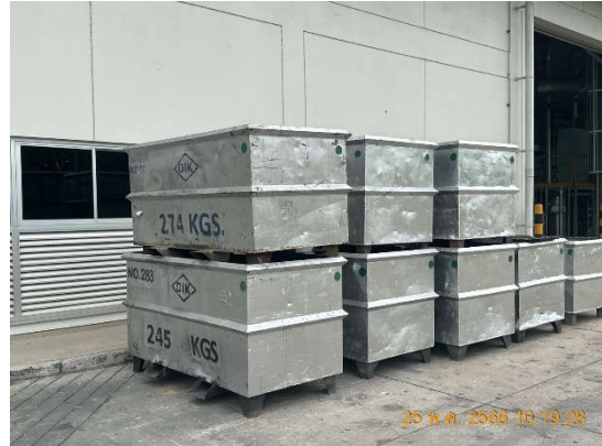
รูปถ่ายที่ 3.2-31 : ถังเหล็กขนาดใหญ่สำหรับเก็บรวบรวม Dross
