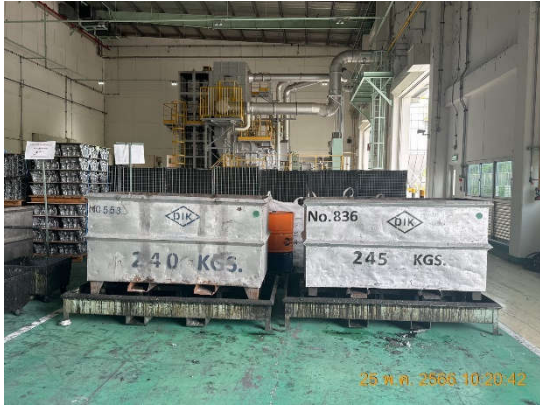
รูปถ่ายที่ 3.2-31 : ถังเหล็กขนาดใหญ่สำหรับเก็บรวบรวม Dross
